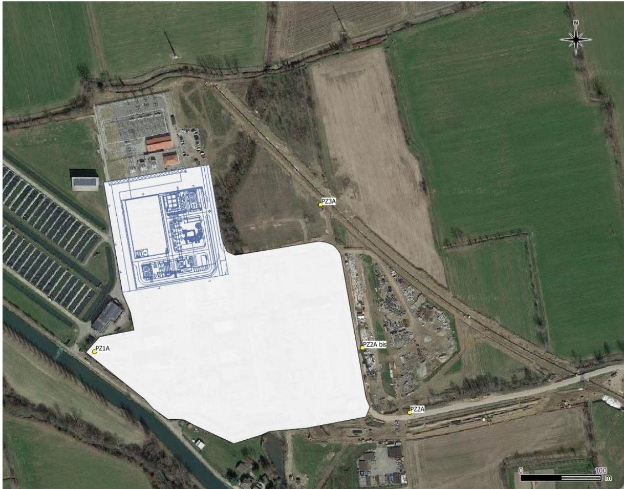
**Figura 3-13 – Ubicazione piezometri di monitoraggio<sup>8</sup>**
