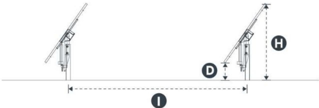
Definizioni delle dimensioni (D = 0,70 m, H = 4,953 m, I = variabile tra 9,20 m e 11,20 m).
