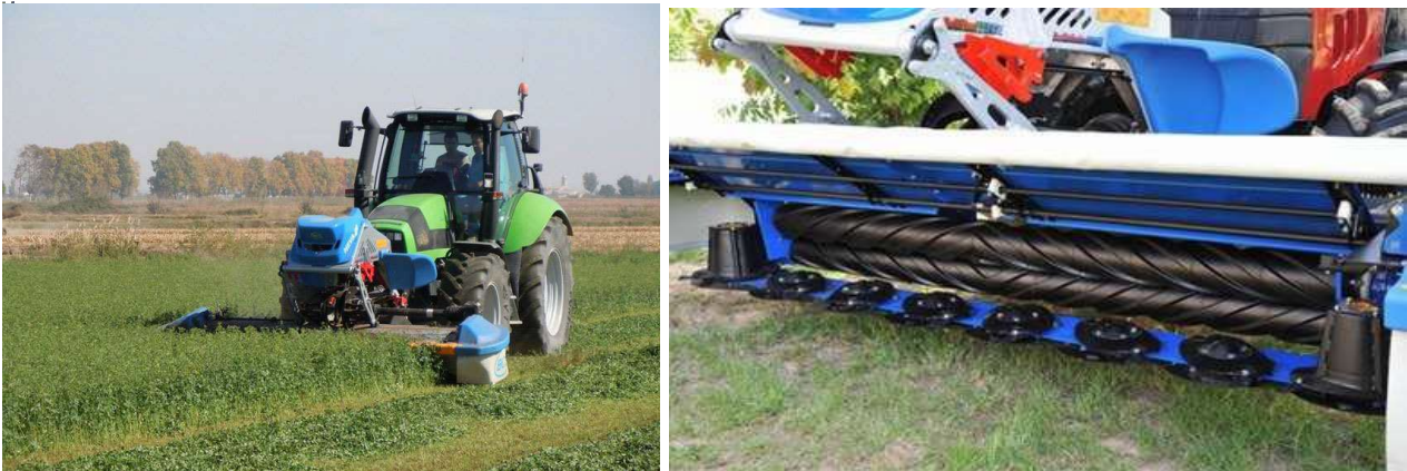
Esempio di falciacondizionatrice frontale e particolare dei rulli in gomma (Foto: BCS).
