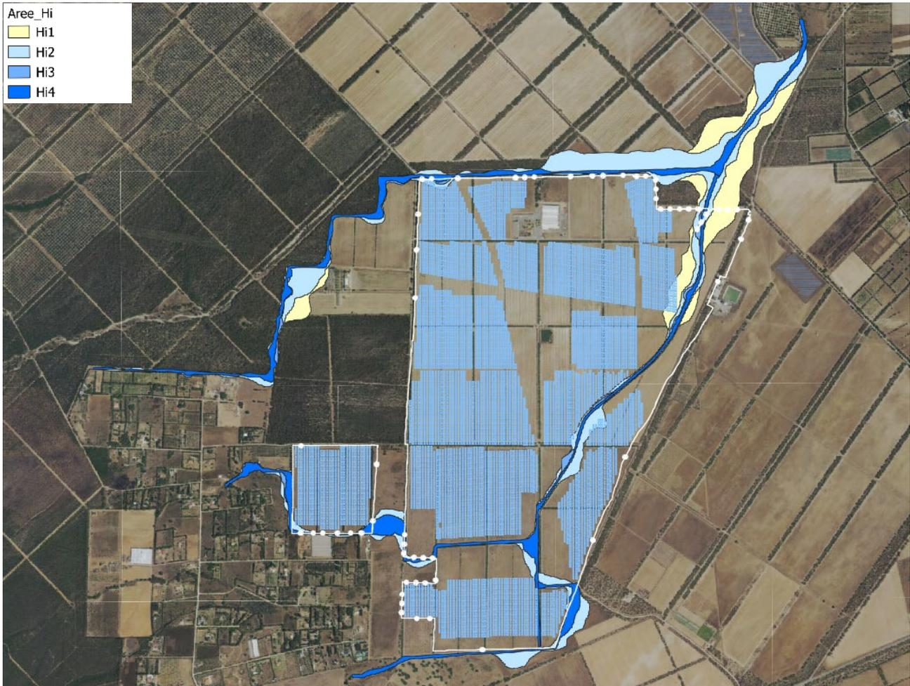
Figura 25 - Studio idraulico con sovrapposizione del layout di progetto.
