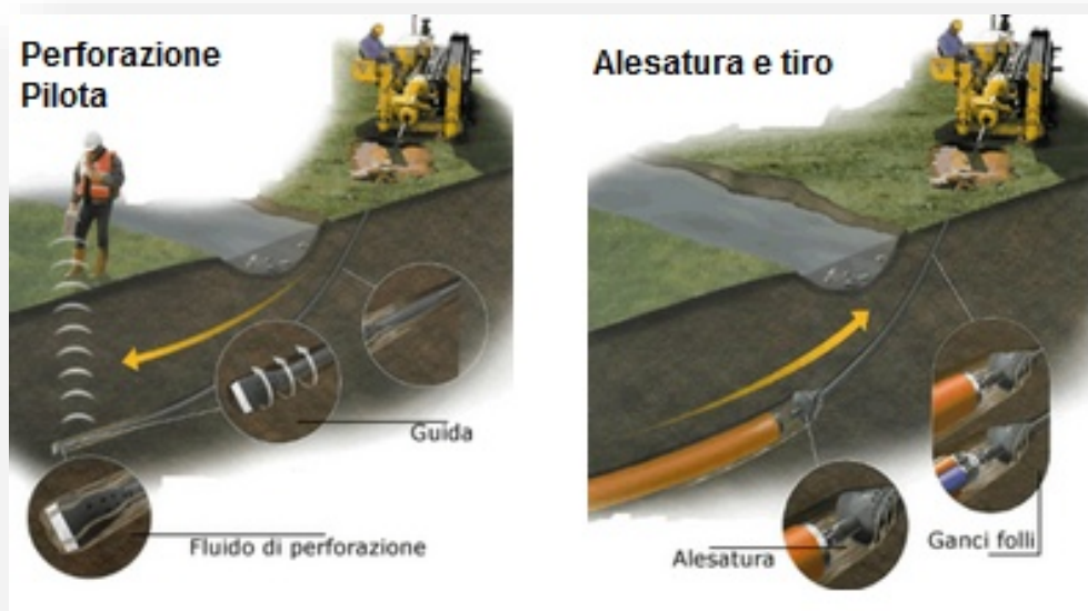
Figura 27 - tecnologia di trivellazione orizzontale controllata (TOC)
