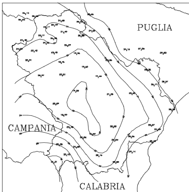
Figura 5-4 Isolinee del coefficiente a della curva di probabilità pluviometrica.
