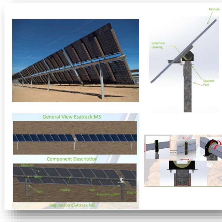
Figura 23 - Strutture di sostegno e sistema di inseguimento solare
