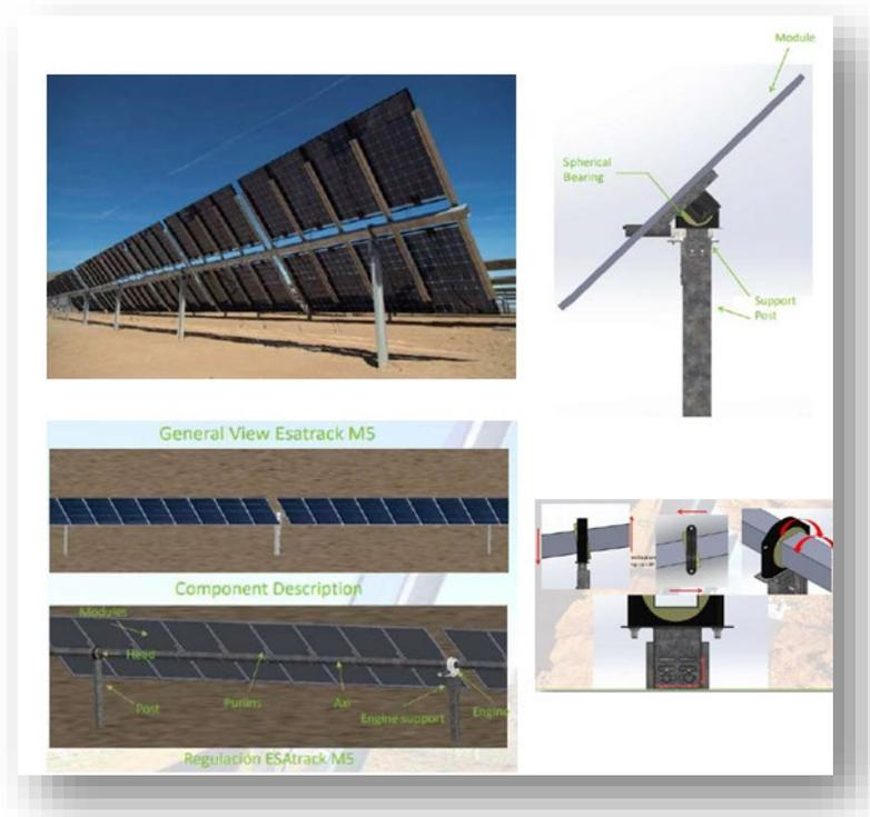
Figura 11 - Strutture di sostegno e sistema di inseguimento solare
