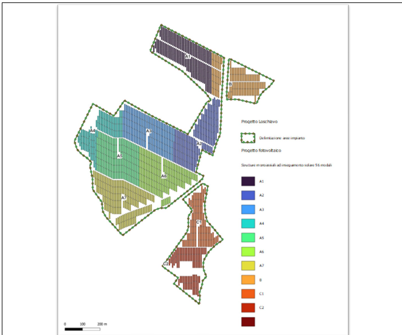
Figura 8 - Estratto Elab. Q.14 Planimetria della suddivisione dei campi (elaborato soggetto a revisione conseguente ad approvazione da parte di terna della proposta di connessione)
