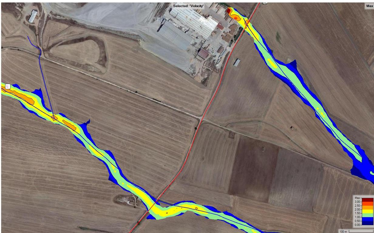
Figura 53. Velocità massime in Zona 4.
