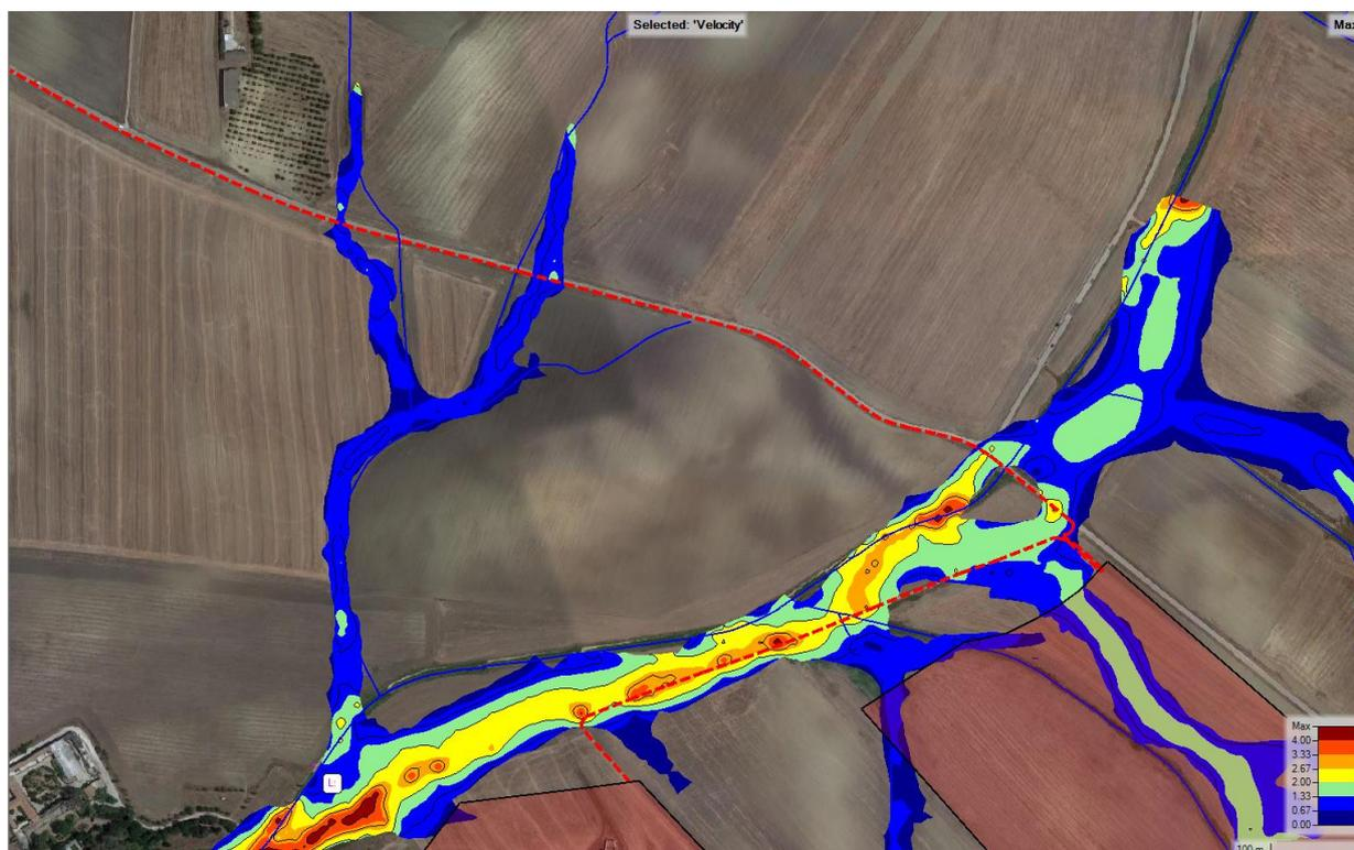
Figura 63. Velocità massime in Zona 7.
