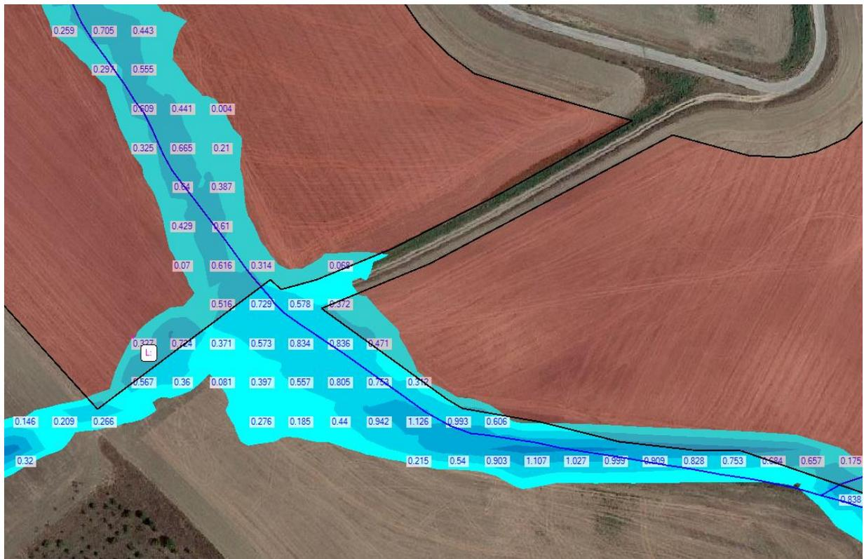
Figura 69. Zoom sull'area 1 di Figura 68 con riporto numerico dei tiranti massimi (Zona 7).
