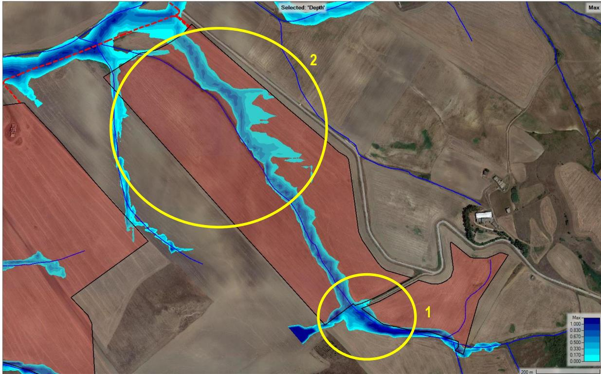
Figura 68. Altezze idriche massime sull'area dell'impianto orientale (Zona 7). Figura 69 e Figura 70 per i dettagli.
