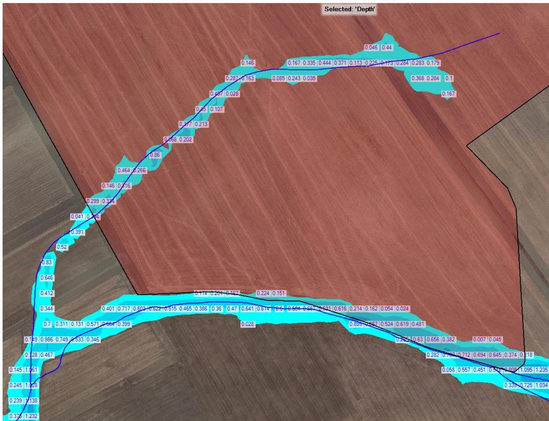
Figura 73 Zoom sull'area 1 di Figura 72 con riporto numerico dei tiranti massimi (Zona 7). Essi possono superare anche mezzo metro.
