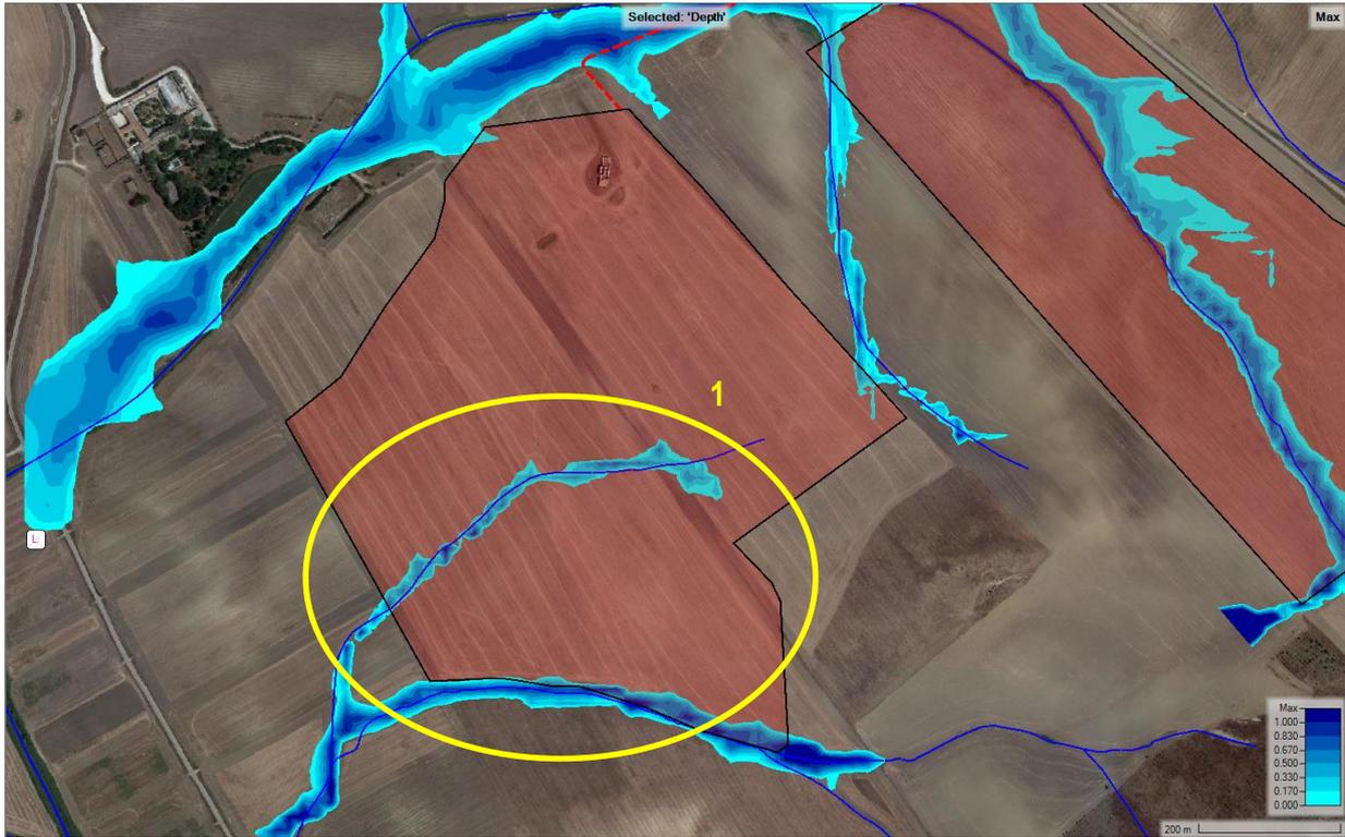
Figura 72. Altezze idriche massime sull'area dell'impianto occidentale (Zona 7).
