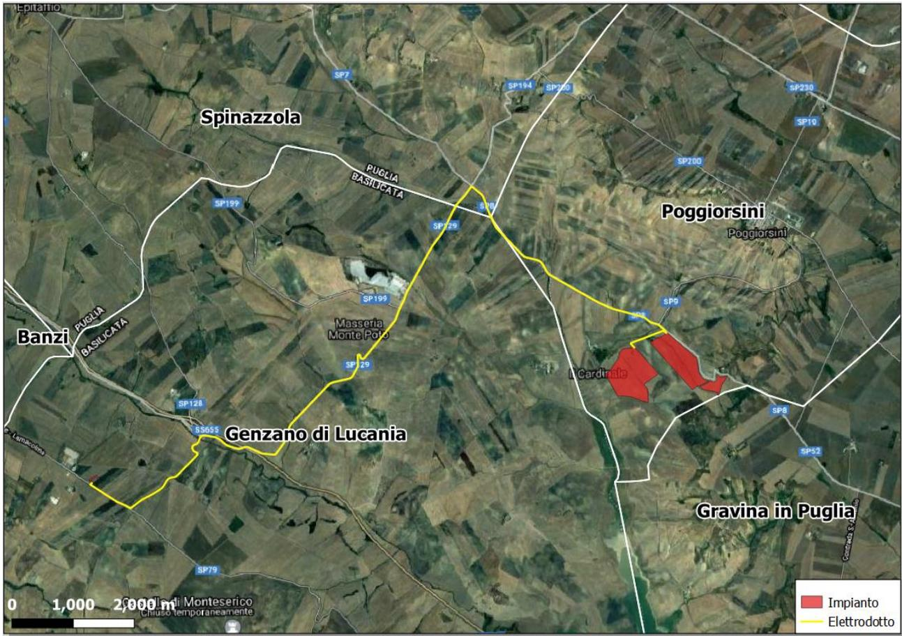
Figura 2. Zoom sul tracciato planimetrico dell' elettrodotto in MT sovrapposto a ortofoto.
