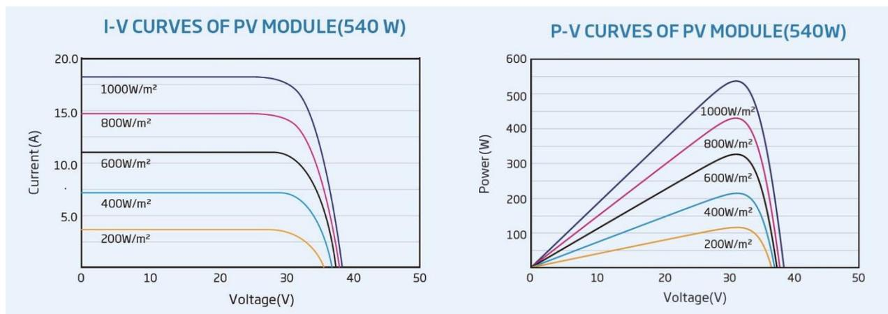
Figura 18 – Parametri elettrici modulo fotovoltaico TRINA SOLAR VERTEX - TSM-DEG19C.20 – 540W
