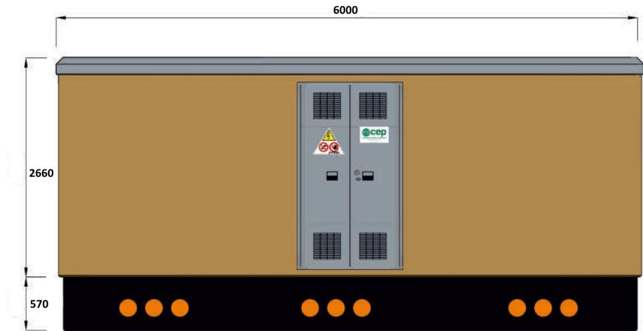
Figura 23 - Cabina elettrica di conversione monoblocco
