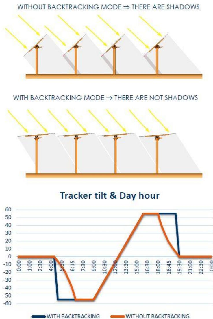
Figura 28 – Principio di gestione in Backtracking
