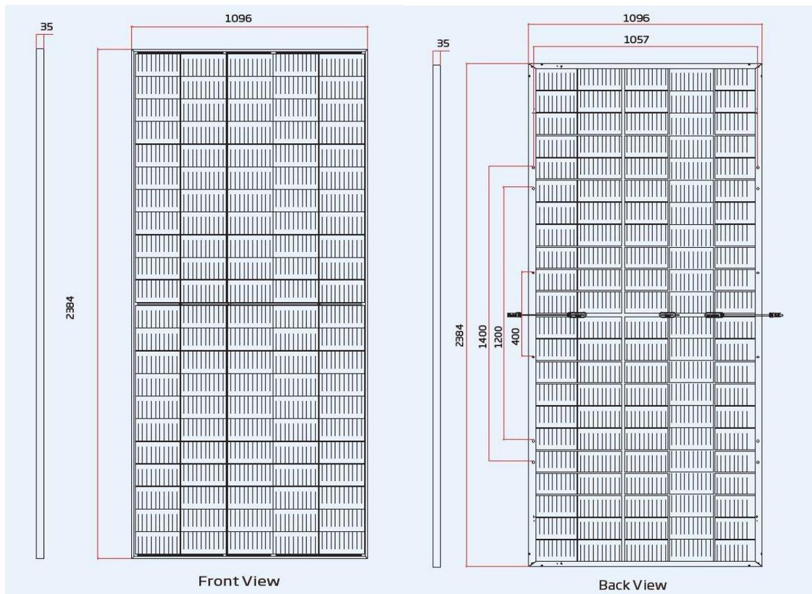
Figura 17 – Dati dimensionali modulo fotovoltaico TRINA SOLAR VERTEX - TSM-DEG19C.20 – 540W
