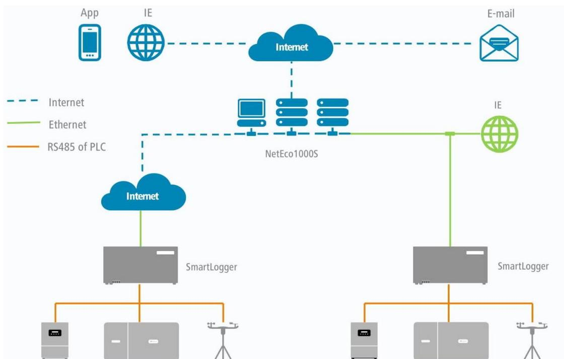
Figura 27 - Schema illustrativo controllo in remoto impianto
