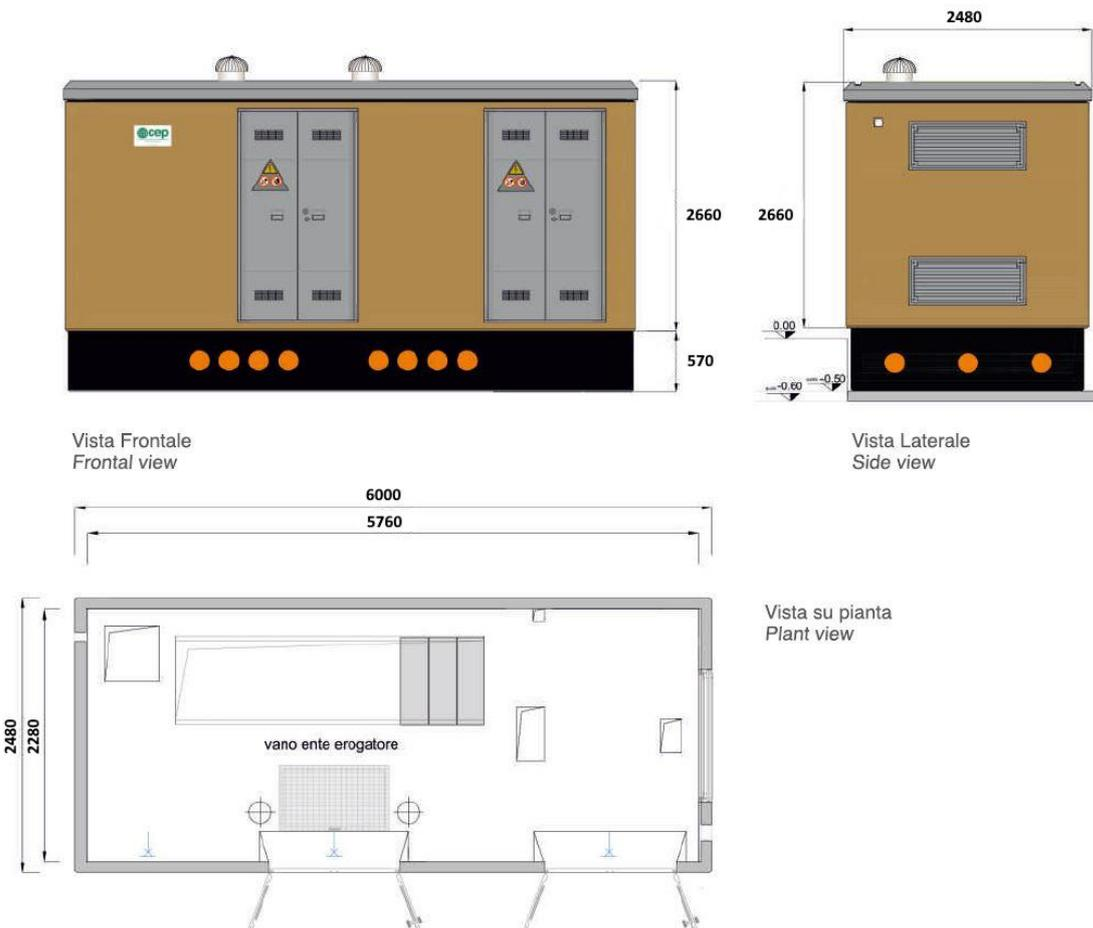
Figura 22 - Cabina elettrica di trasformazione monoblocco
