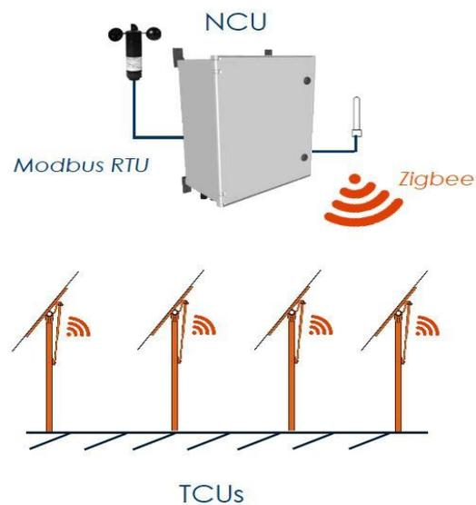
Figura 29 – Modalità di comunicazione sistema ad inseguimento solare
