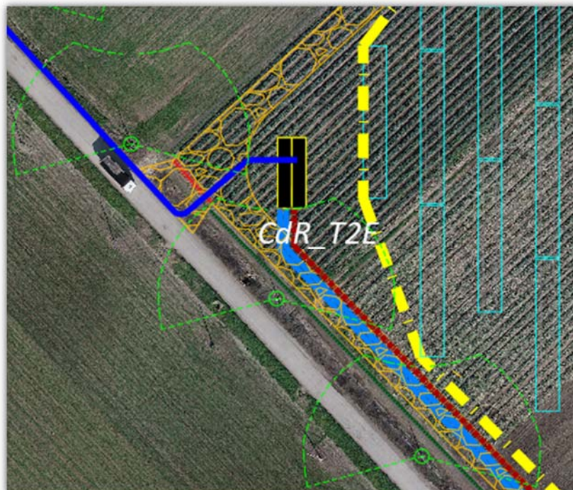
Fig. 27. Dettaglio della CdR EST: in rosso scuro, la linea proveniente dalle varie cabine di conversione e trasformazione; in blu la dorsale proveniente dalla CdR_T2C; in celeste le linee dorsali in partenza verso la Sottostazione Produttore
