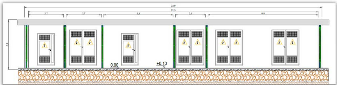
Fig. 44. Prospetto principale dei locali tecnici della SSE.
