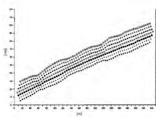
dove  $T_{S1Y}$  e  $T_{S2X}$  sono i tempi di percorrenza dei raggi sismici per giungere, rispettivamente, dalla sorgente S1 ad X e dalla sorgente S2 ad Y mentre  $T_{S1S2}$  è il tempo di tragitto tra i due punti di scoppio S1 ed S2, esternamente simmetrici rispetto allo stendimento.  $T_V$  è il tempo calcolato su un geofono G posto tra X ed Y, non necessariamente coincidente con la posizione di un geofono dello stendimento.
