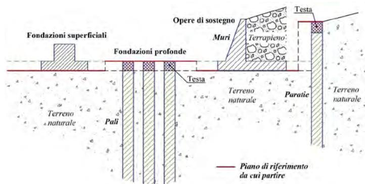
**Figura 2 – Schemi di riferimento richiamati al § 3.2.2 delle NTC 2018.**
