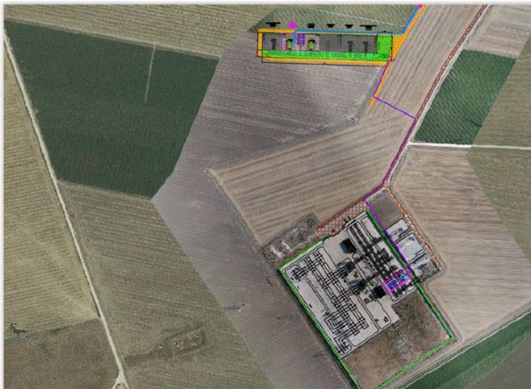
Fig.1A Inquadramento su ortofoto opere di Rete: in azzurro, l'elettrodotto dorsale MT 30kV; in arancio, la viabilità di accesso; in Magenta, la SSE Produttore; in viola, l'elettrodotto AT 150kV; riquadrata in rosso, la posizione dello Stallo 150kV assegnato.
