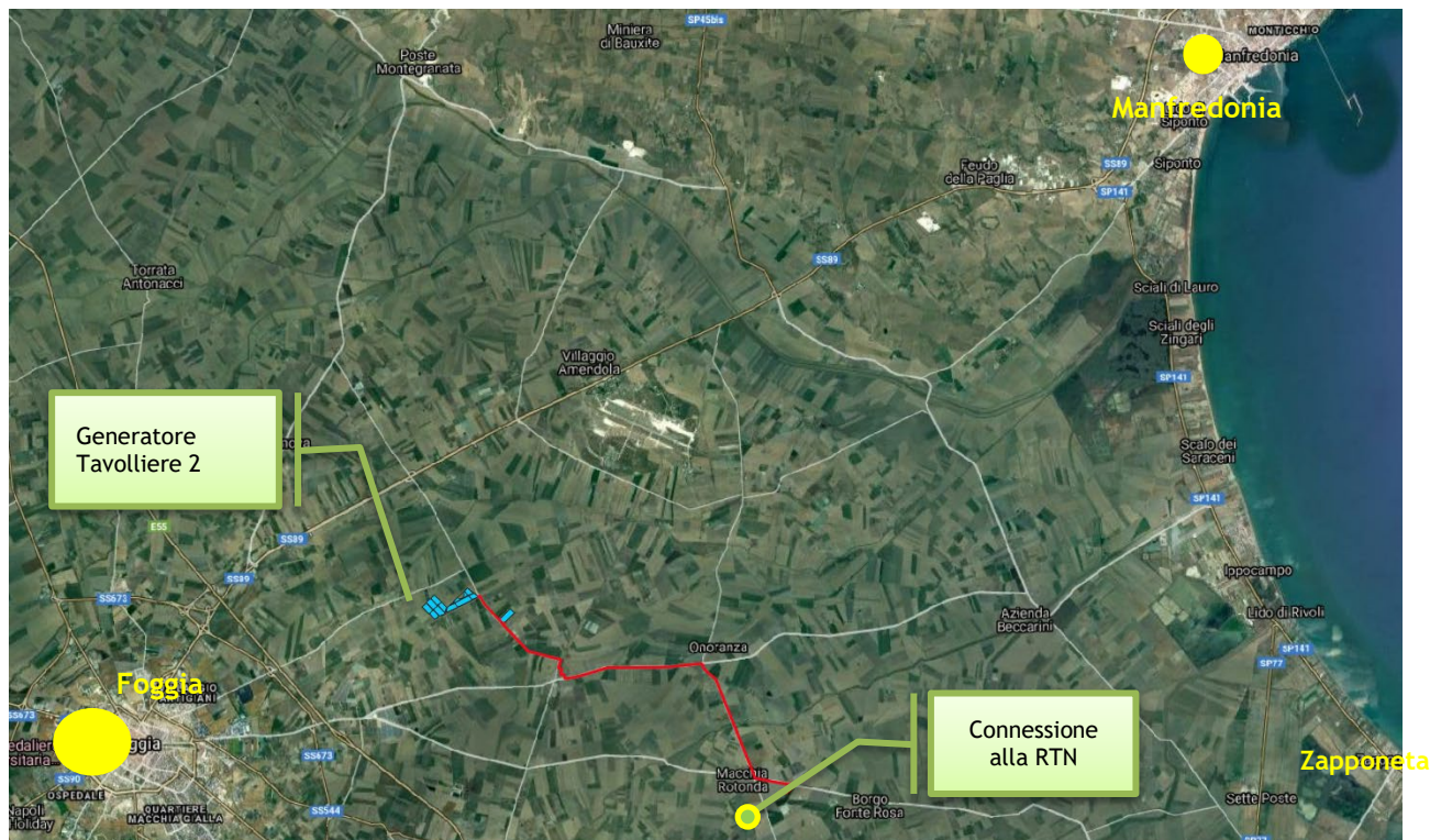
Fig. 2. Inquadramento di ampio raggio su ortofoto dell'area di intervento, situata all'incirca a circa 10km ad Est-Nord-Est di Foggia: in celeste, la centrale fotovoltaica; in rosso, il percorso dell'elettrodotto dorsale, che si sviluppa per circa 12km prevalentemente lungo rete viaria esistente; a SUD la Sottostazione Produttore, nei pressi della esistente Stazione elettrica di Trasformazione SET-TERNA 380/150kV.
