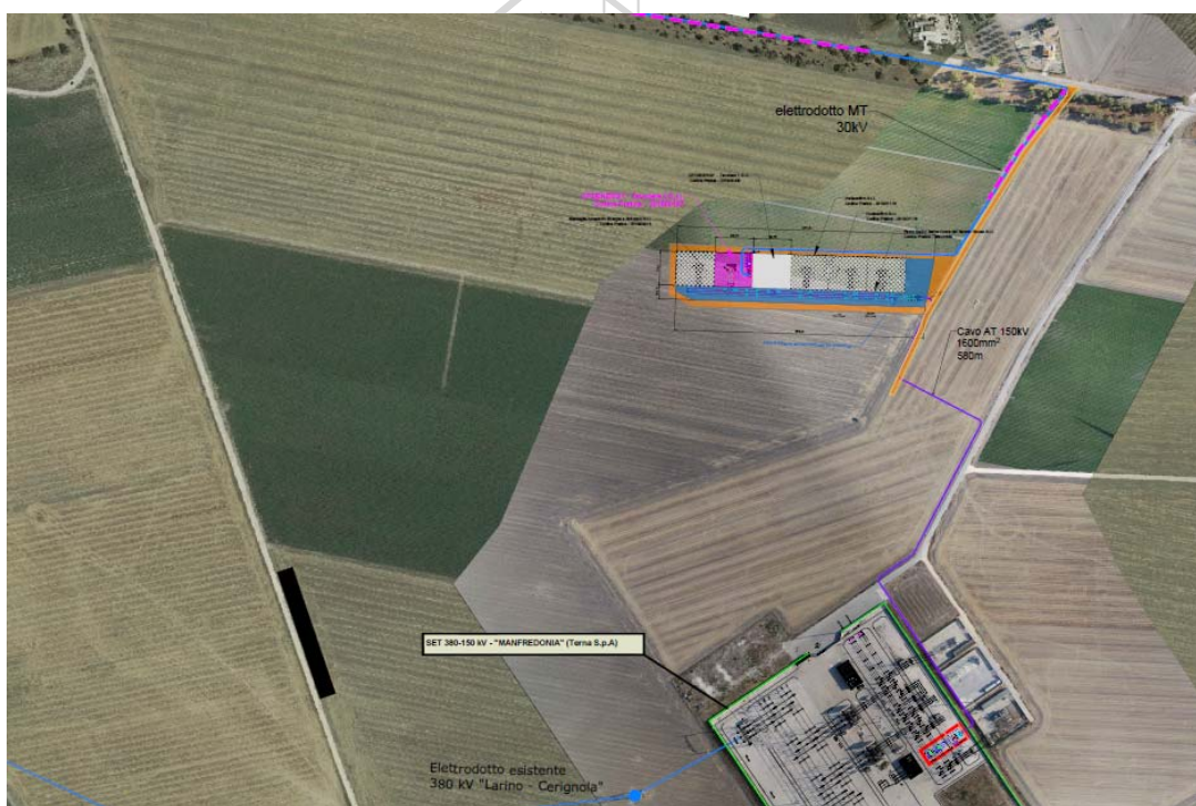
Fig. 1. Inquadramento su ortofoto opere di Rete: in azzurro, l'elettrodotto dorsale MT 30kV; in arancio, la viabilità di accesso; in Magenta, la SSE Produttore; in viola, l'elettrodotto AT 150kV; riquadrata in rosso, la posizione dello Stallo 150kV assegnato.
