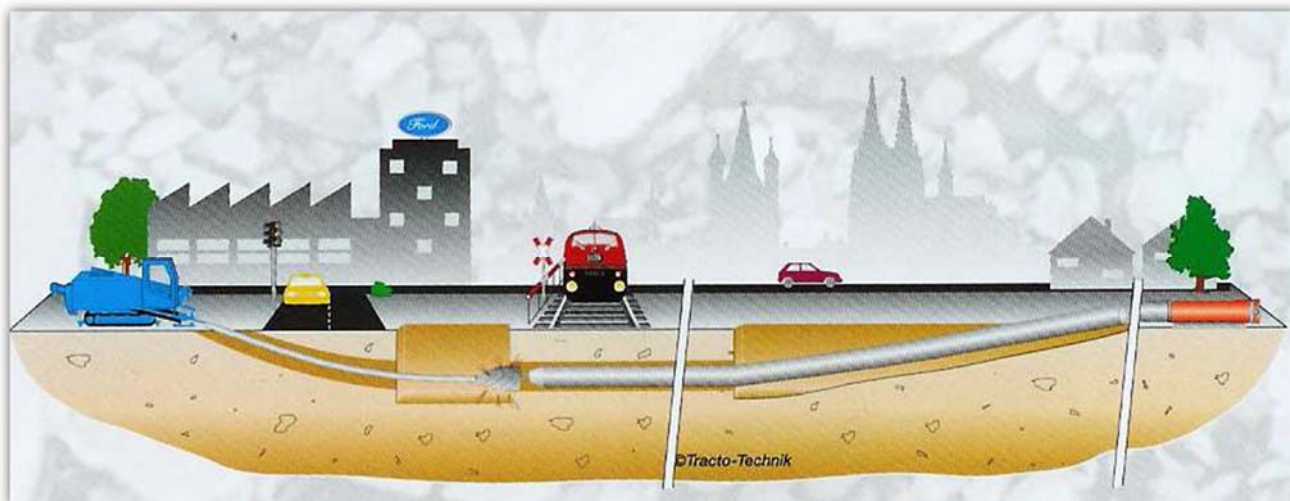
Fig. 7. Schema di principio dell'attraversamento in T.O.C.
