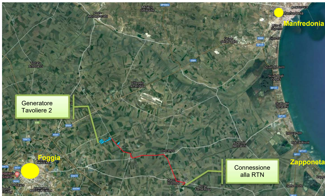
Fig. 3. Inquadramento di ampio raggio su ortofoto dell'area di intervento, situata all'incirca a circa 10km ad Est di Foggia; a Nord, in celeste, la centrale fotovoltaica; in rosso, il percorso dell'elettrodotta dorsale, che si sviluppa per circa 12km prevalentemente lungo rete viaria esistente; a SUD la Sottostazione Produttore, nei pressi della esistente Stazione elettrica di Trasformazione SET-TERNA 380/150kV.
