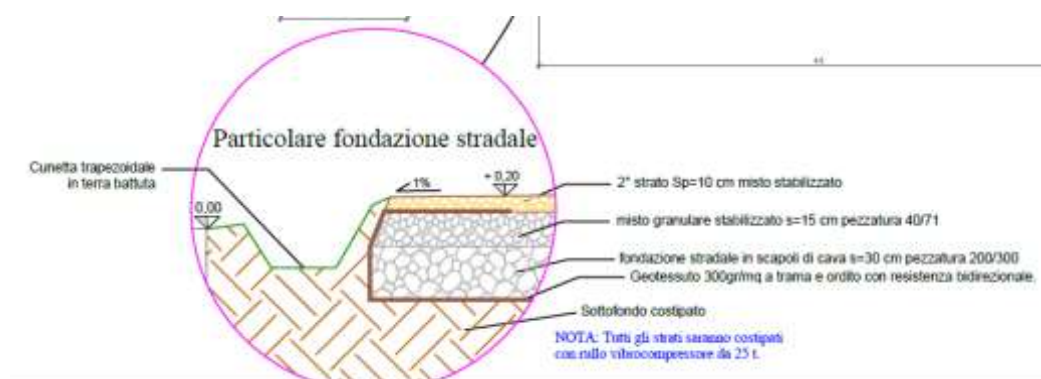
Fig. 22. Sezione tipo viabilità interna al parco
