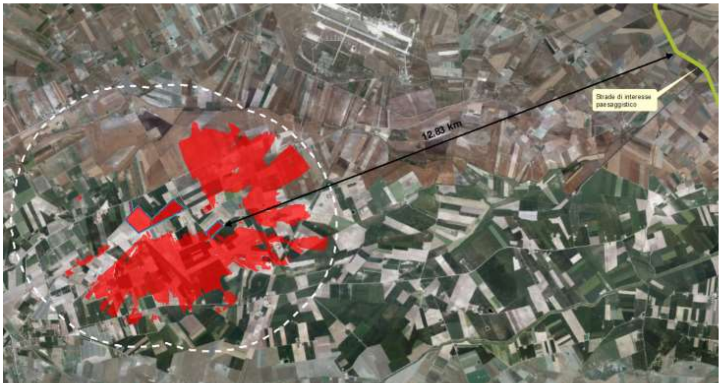
Fig. 39. Intervisibilità del progetto in rapporto alle componenti dei Valori Percettivi (in rosso le aree visibili)
