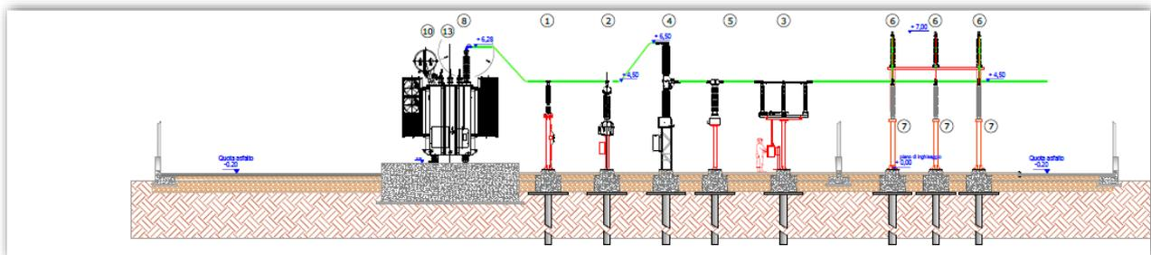
Fig. 2. Sezione elettromeccanica del montante di trasformazione MT/AT
