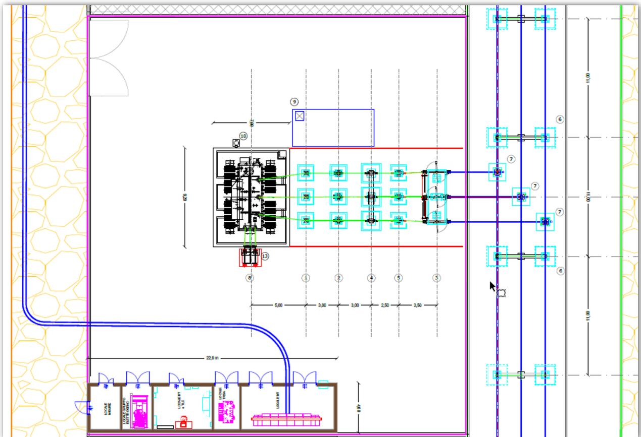
Fig. 1. Planimetria elettromeccanica della SSE, con stralcio delle sbarre principali per la condivisione di Stallo.
