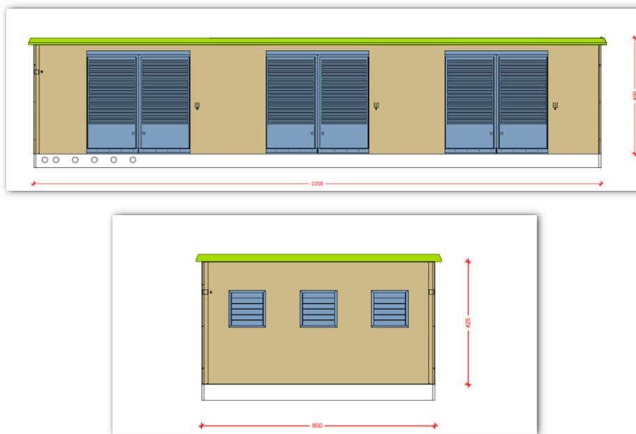
Prospetto anteriore (in alto) e laterale (in basso) del locale magazzino
