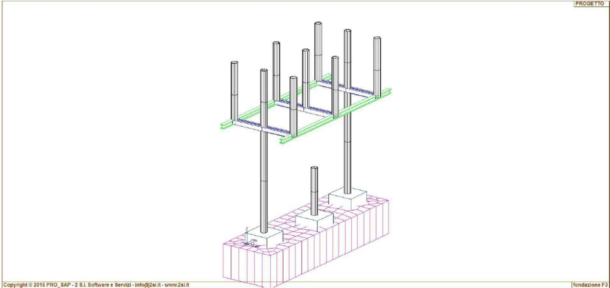
*Modellazione Fondazione Sezionatore Tripolare*
