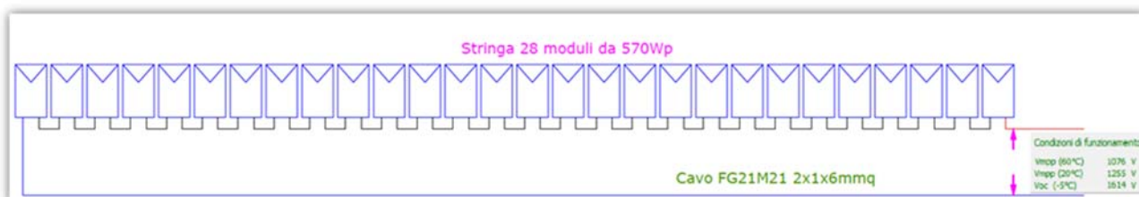
Fig. 2. Particolare serie moduli fotovoltaici
