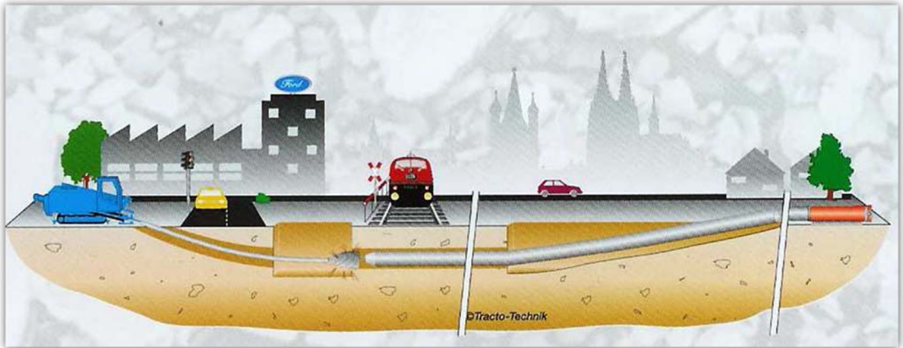
Fig. 9. Schema di principio dell'attraversamento in T.O.C.
