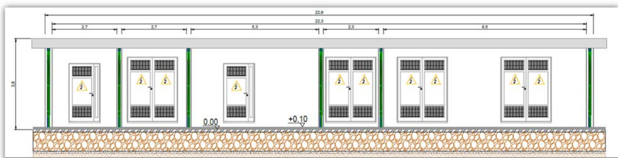
Fig. 14. Prospetto principale dei locali tecnici della SSE.
