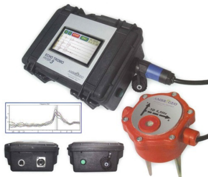
Figura 9.3 – Indagini sismiche. Tromografo AMBROGEO Echo Tromo Hvsr 3
