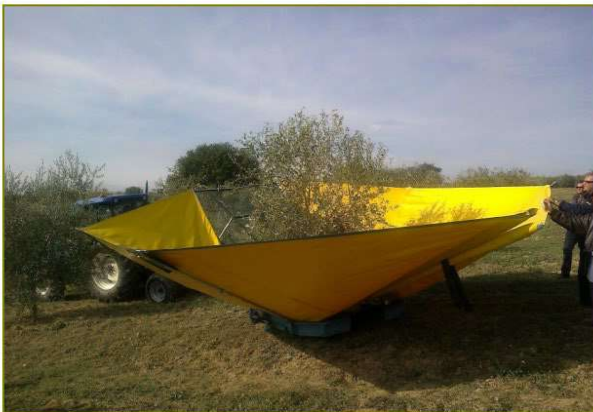
Fig.54 - Raccolta meccanizzata con braccio vibratore e telaio intercettatore ad ombrello rovesciato.
