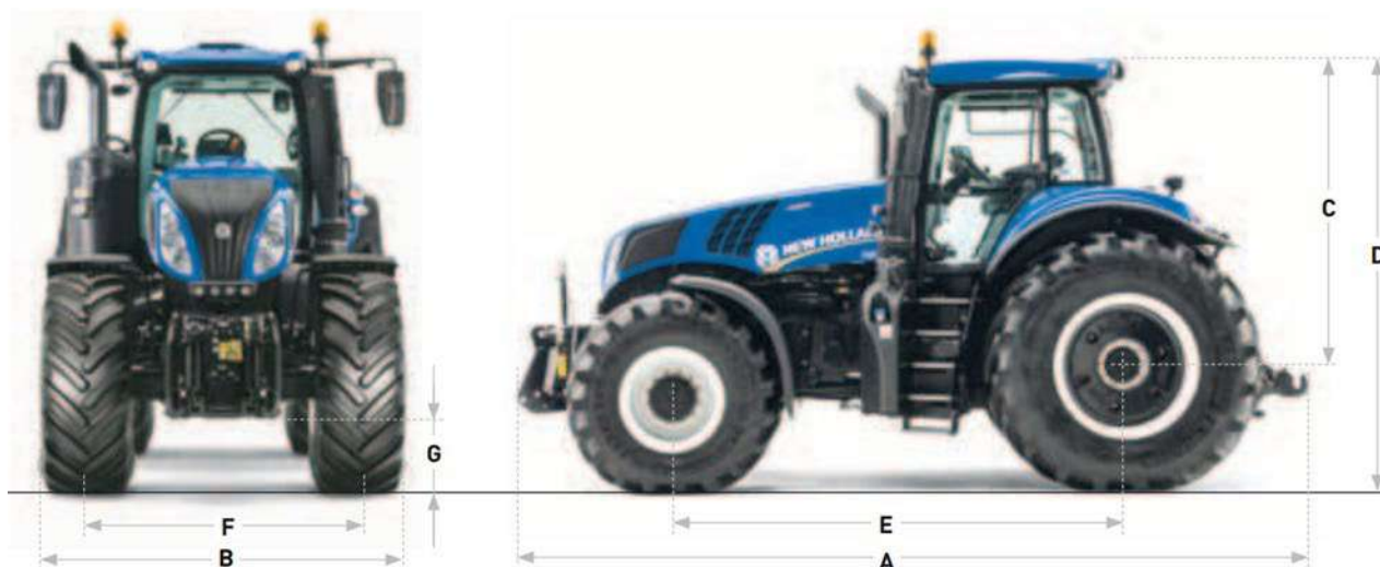
Fig. 43: Dimensioni del più grande dei trattori gommati convenzionali prodotti dalla NEW HOLLAND
