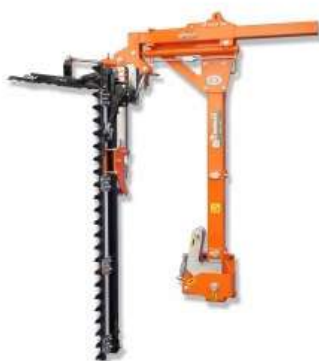
Fig.50 - Compressore con attacco pto e cimatrice.
