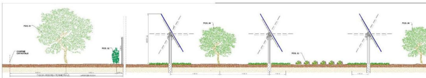
Figura 50– Sezione mitigazione dell'impatto visivo
