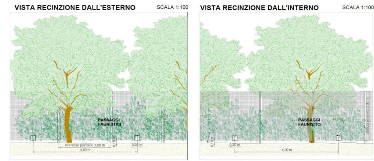
Fig. 14 - Dettaglio della recinzione dell'impianto agro-fotovoltaico
