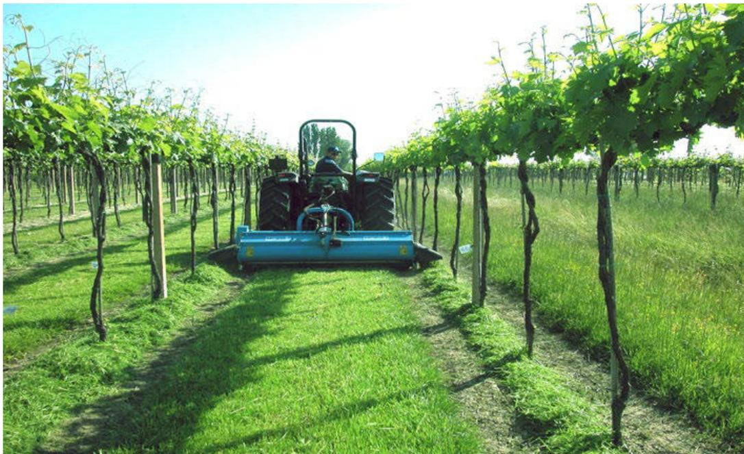
**Inerbimento con sfalcio mediante trincer**
