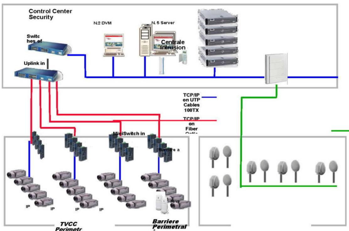
Figura 10 – Schema del Sistema di sorveglianza
