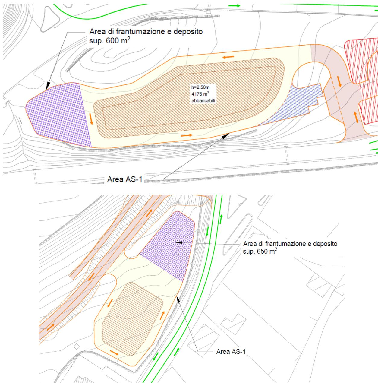
In tali aree è previsto lo stoccaggio provvisorio dei materiali di approvvigionamento e di tutti i materiali provenienti dalle lavorazioni, prevalentemente dagli scavi per la realizzazione dei tratti in trincea e per la realizzazione delle fondazioni delle opere d'arte.
