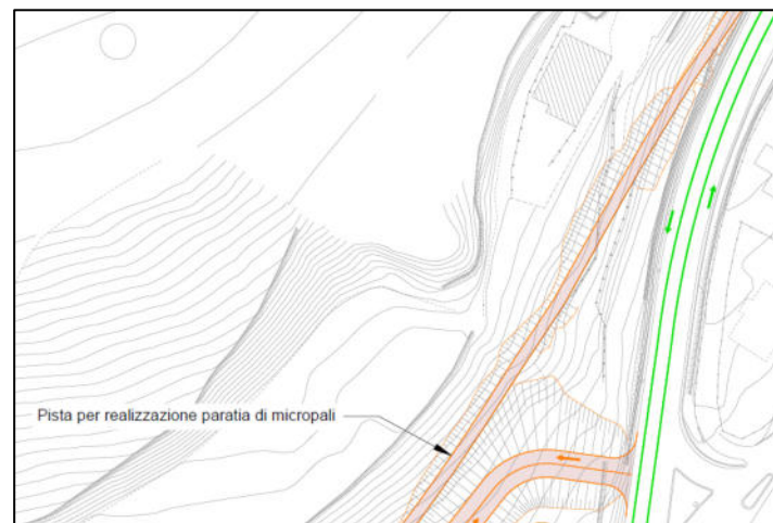
Figura 126 – Dettaglio della pista per la realizzazione dei micropali
