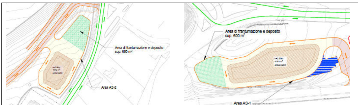
Figura 9 - Particolare Aree AS-1 (zona sud del cantiere) e AS-2 (zona nord del cantiere) di stoccaggio e area di frantumazione
