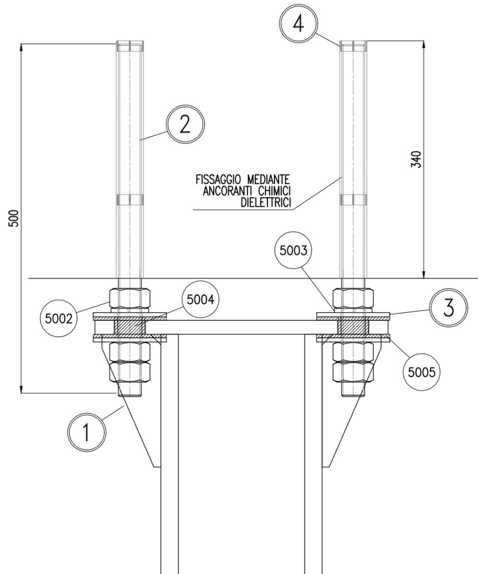
**MATERIALE NECESSARIO PER L'ANCORAGGIO DI UN SUPPORTO PENDULO PER SOSPENSIONE LINEA DI CONTATTO**
