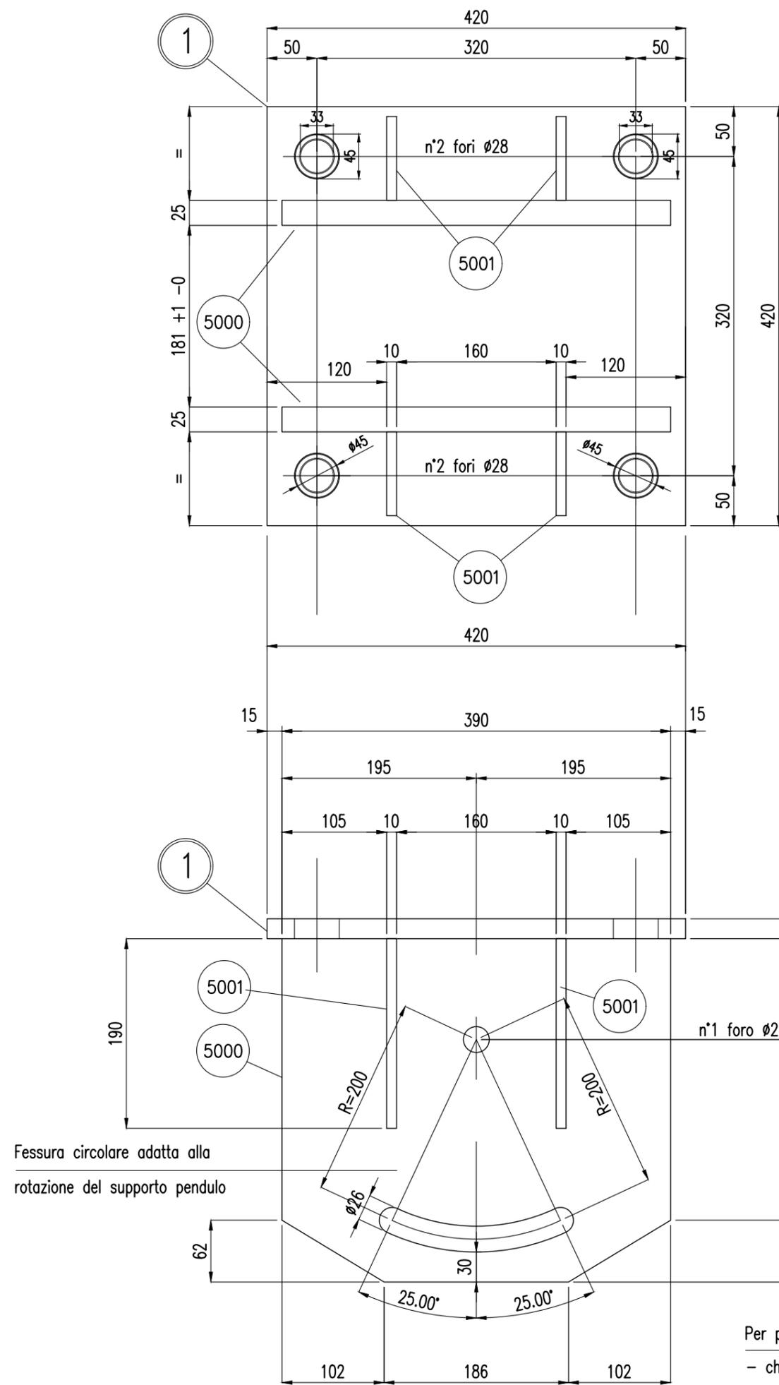
**MATERIALE NECESSARIO PER LA PIASTRA D'ATTACCO DI UN SUPPORTO PENDULO PER SOSPENSIONE LINEA DI CONTATTO**
