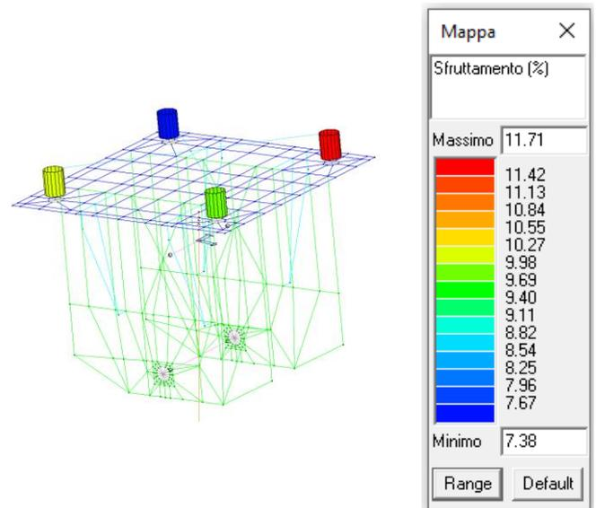
Riportiamo in forma tabellare i valori delle verifiche eseguite per ogni elemento finito rappresentante i tirafondi (acciaio inox A4-70) in condizione D:
