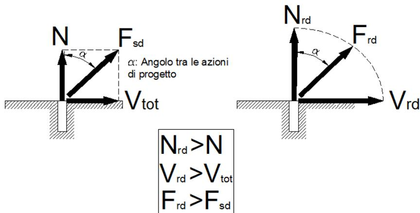
In entrambi i casi si individua la condizione più gravosa (cioè quella che offre una minore resistenza) confrontando il comportamento dell'acciaio e del calcestruzzo. Alla fine le minori resistenze vengono combinate per la verifica cosiddetta a "Carico Combinato" confrontandole con le massime azioni agenti sugli ancoranti.
