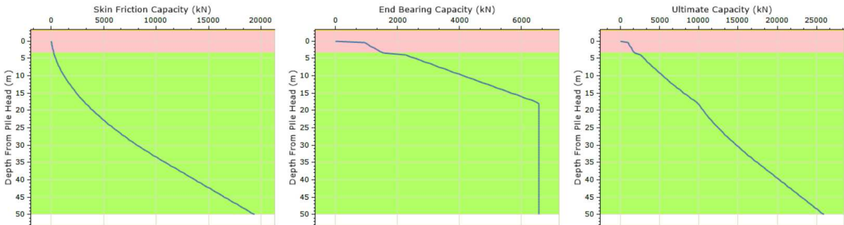
Figura 9-2 – Curve a trazione non fattorizzate
