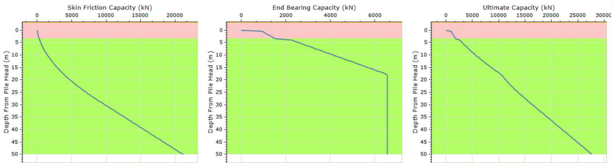
Figura 9-1 – Curve a compressione non fattorizzate
