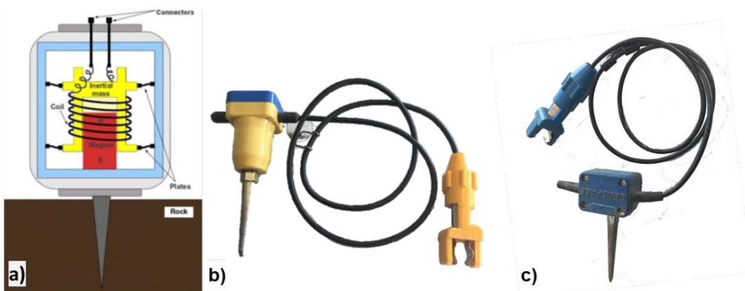
Figura 6 – Geofoni per onda P ed Sh; a) schema di funzionamento del geofono per onda P; b) geofono per onda P con frequenza caratteristica di 4.5 Hz; c) geofono per onda S con frequenza caratteristica di 8 Hz (utilizzato esclusivamente per la sismica a rifrazione).
