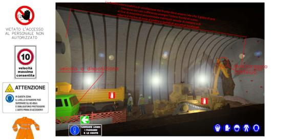
Lo scavo al fronte viene eseguito utilizzando un escavatore dotato di martello demolitore. Prima di dare inizio ai lavori, l'escavatore verificherà il corretto funzionamento del climatizzatore di bordo.
