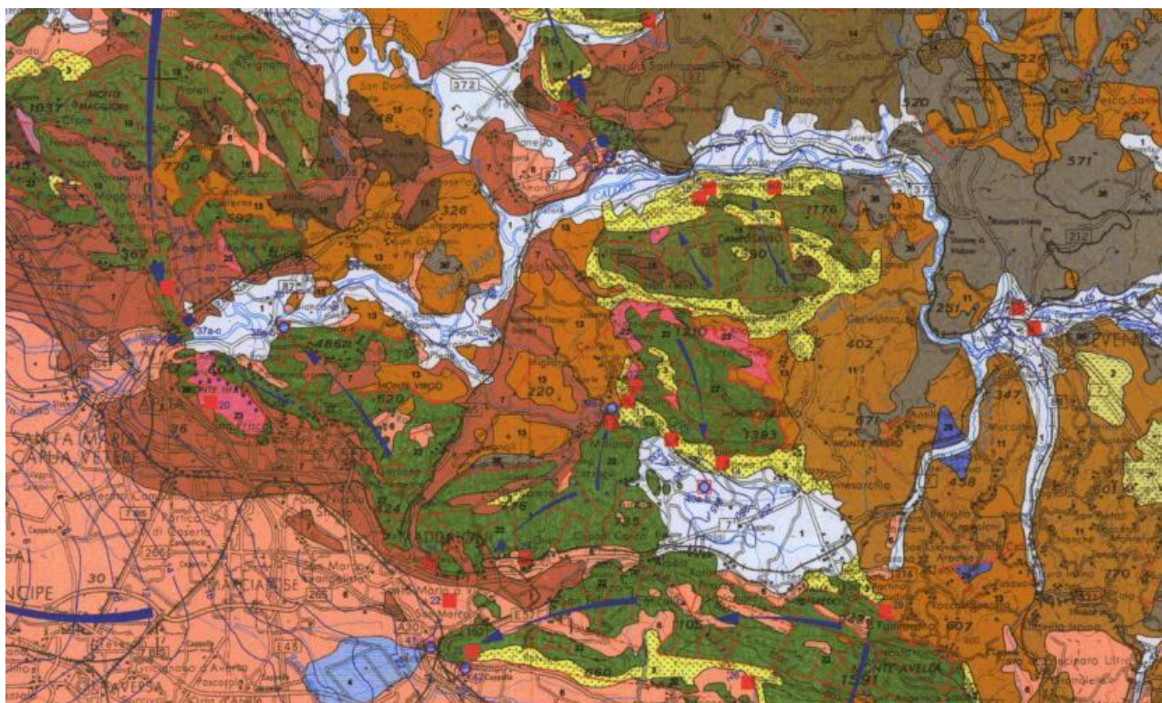
Stralcio della Carta idrogeologica dell'Italia Meridionale, con indicazione delle principali sorgenti e direttrici di flusso (da Celico et al. 2007)
