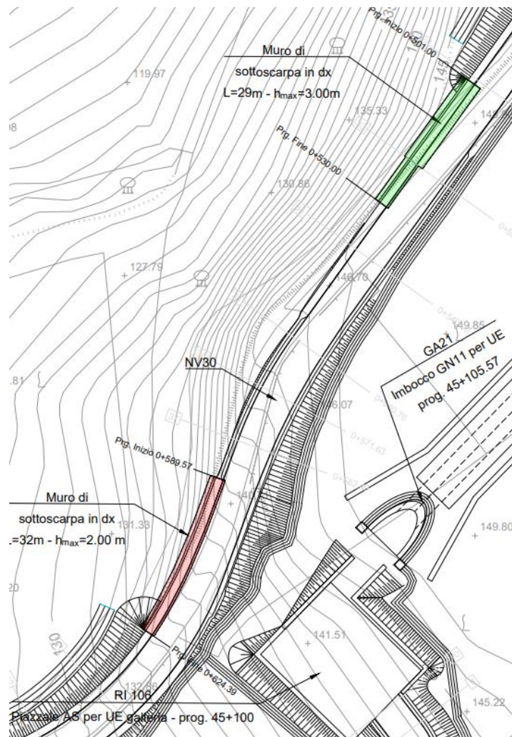
Figura 39 - muri di NV30-tratto 1
