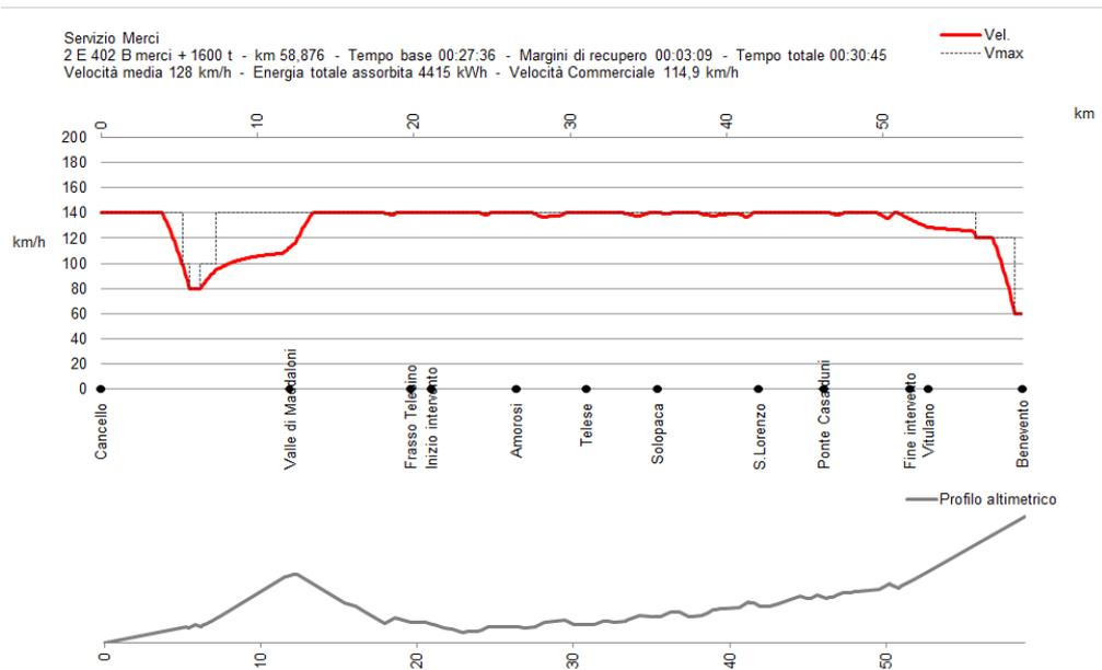
Figura 11: Diagramma spazio-velocità per il servizio merci, nel senso di marcia Cancellò-Benevento.
