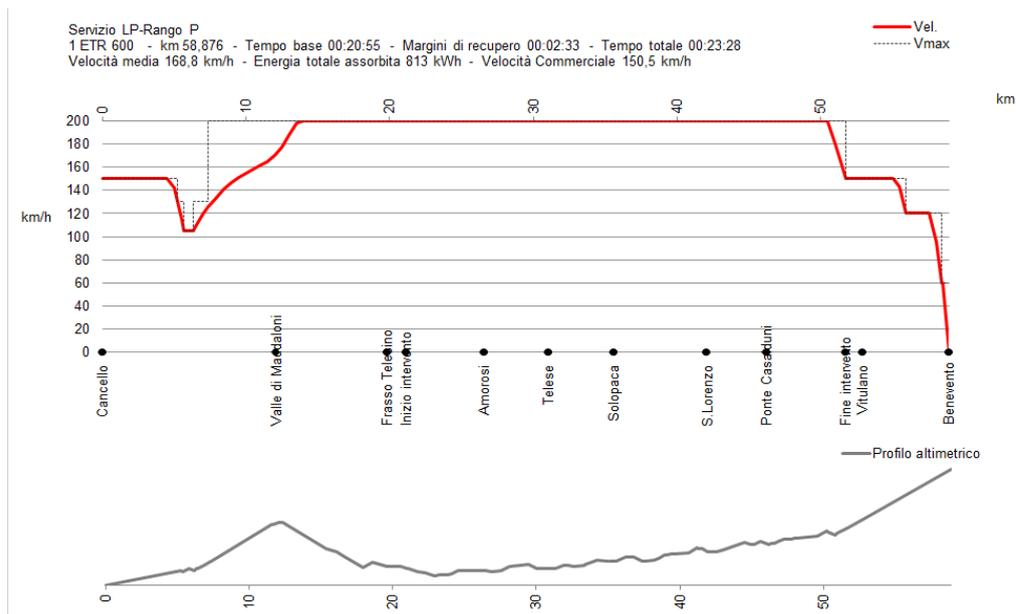
Figura 7: Diagramma spazio-velocità per il servizio Lunga percorrenza con ETR600, nel senso di marcia Cancellone-Benevento.
