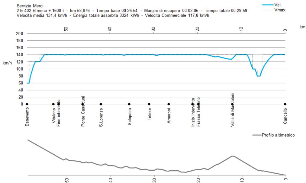
Figura 12: Diagramma spazio-velocità per il servizio merci, nel senso di marcia Benevento-Cancellò.
