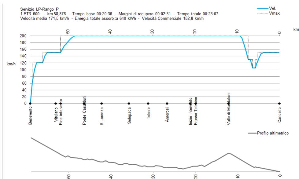
Figura 8: Diagramma spazio-velocità per il servizio Lunga percorrenza con ETR600, nel senso di marcia Benevento-Cancellone
