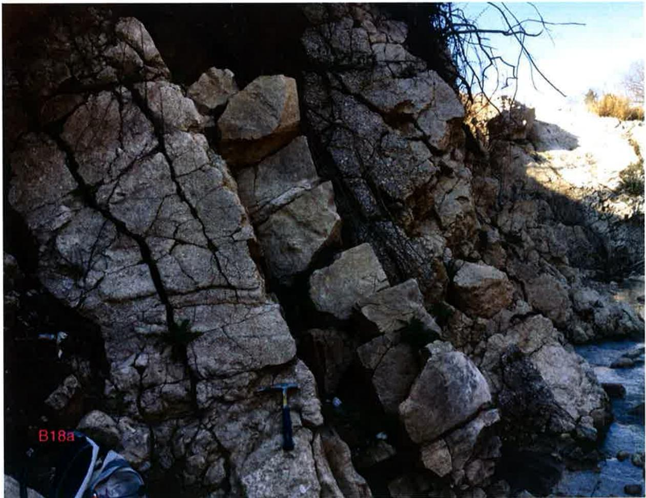
Foto 1 – Litotipi calcareo-dolomitici delle Argille Varicolori Superiori (ALVc) affioranti in corrispondenza della stazione strutturale S07, poco a sud dell'imbocco della Galleria Le Forche in sinistra idrografica del Torrente Reventa.
