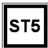
Figure 10: Caisson lumineux 40cm x 40cm d'indication des abris et des ST dans la galerie.
