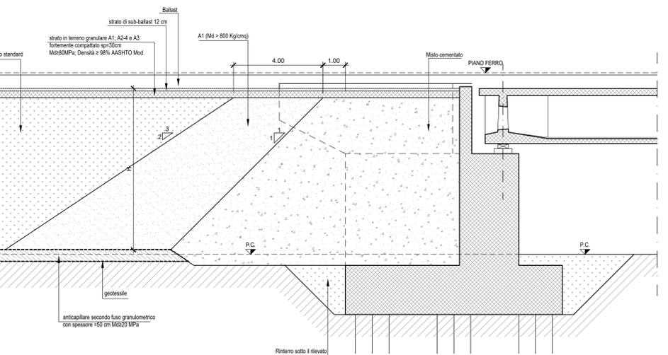
SEZIONE DI TRANSIZIONE RILEVATO-VIADOTTO
