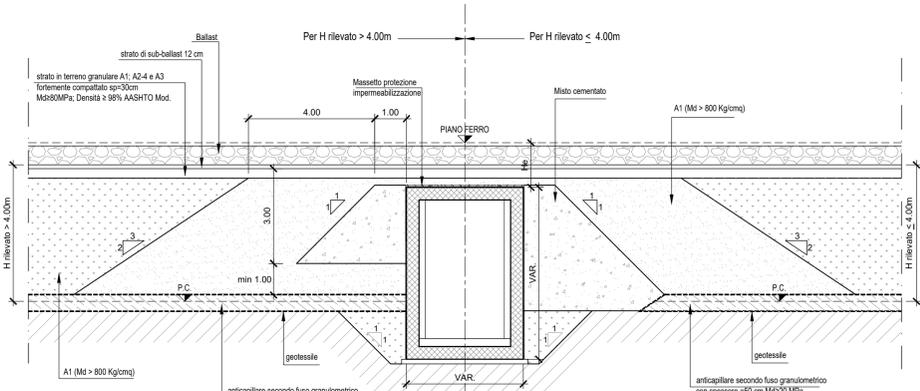
SEZIONE DI TRANSIZIONE RILEVATO-VIADOTTO
