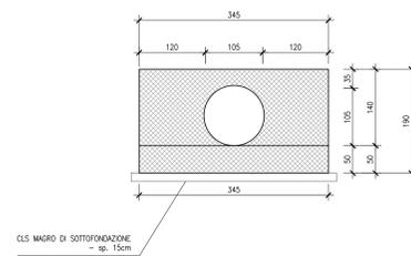
SEZIONE DI POSA TUBO Ø800
