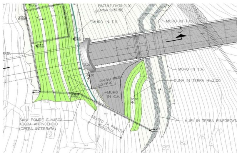
Fig. 3.4.3 – Dettaglio planimetrico del piazzale tecnico con duna di sicurezza (cfr. AUA0121-2)
