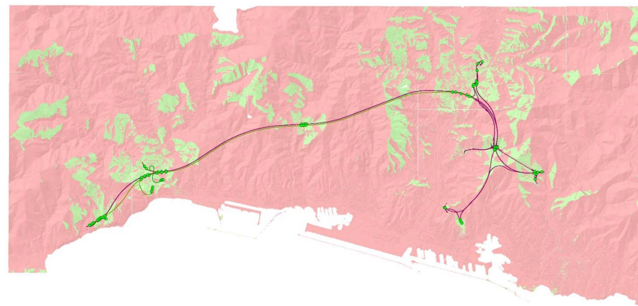
Figura 2-9 Esito della viewshed analysis: in verde l'ambito di interferenza visiva assoluta della nuova infrastruttura
