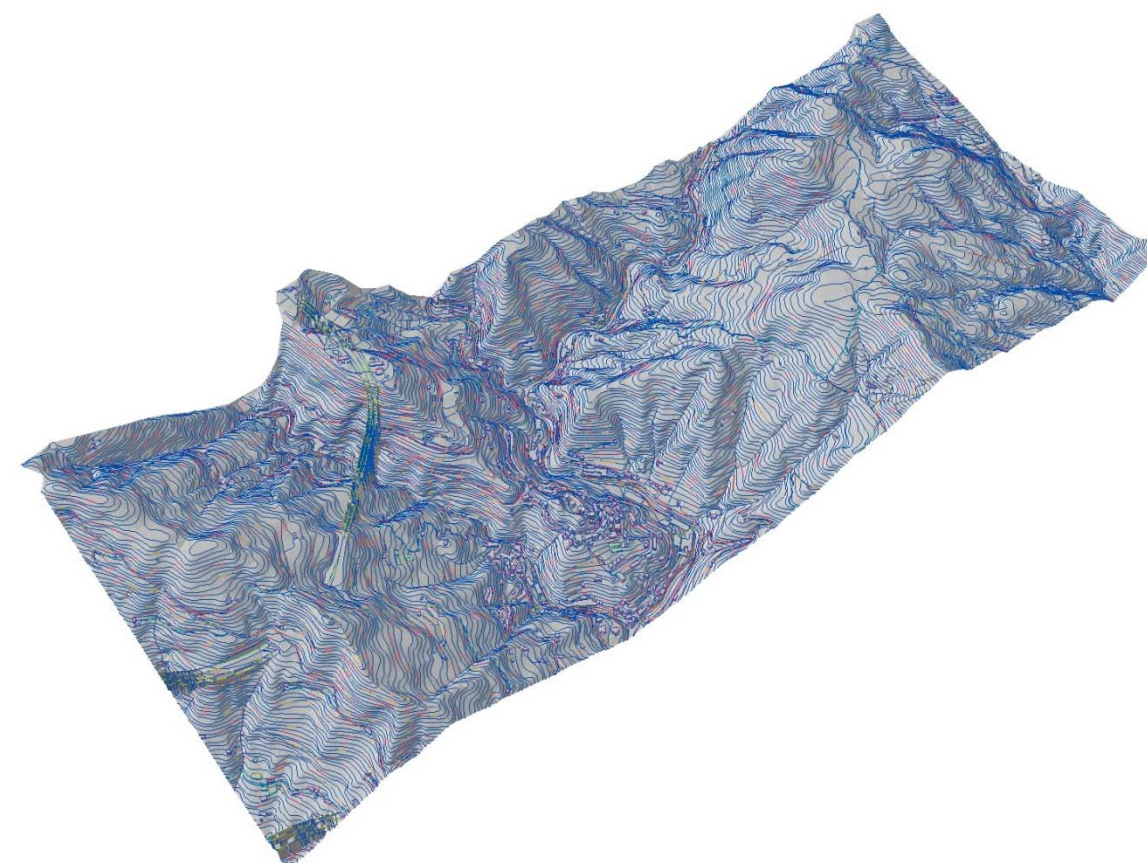
Figura 2-2 Costruzione del modello tridimensionale a triangoli del quadrante 50af03xt
