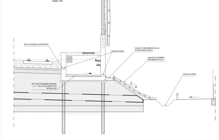
SEZIONE TIPO IN TRINCEA - BANCHINA FFP
