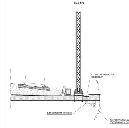
SEZIONE TIPO IN RILEVATO - BANCHINA FFP
