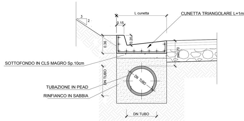
DRENAGGIO ACQUE DI PIATTAFORMA STRADALE IN TRINCEA - SEZIONE C-C
