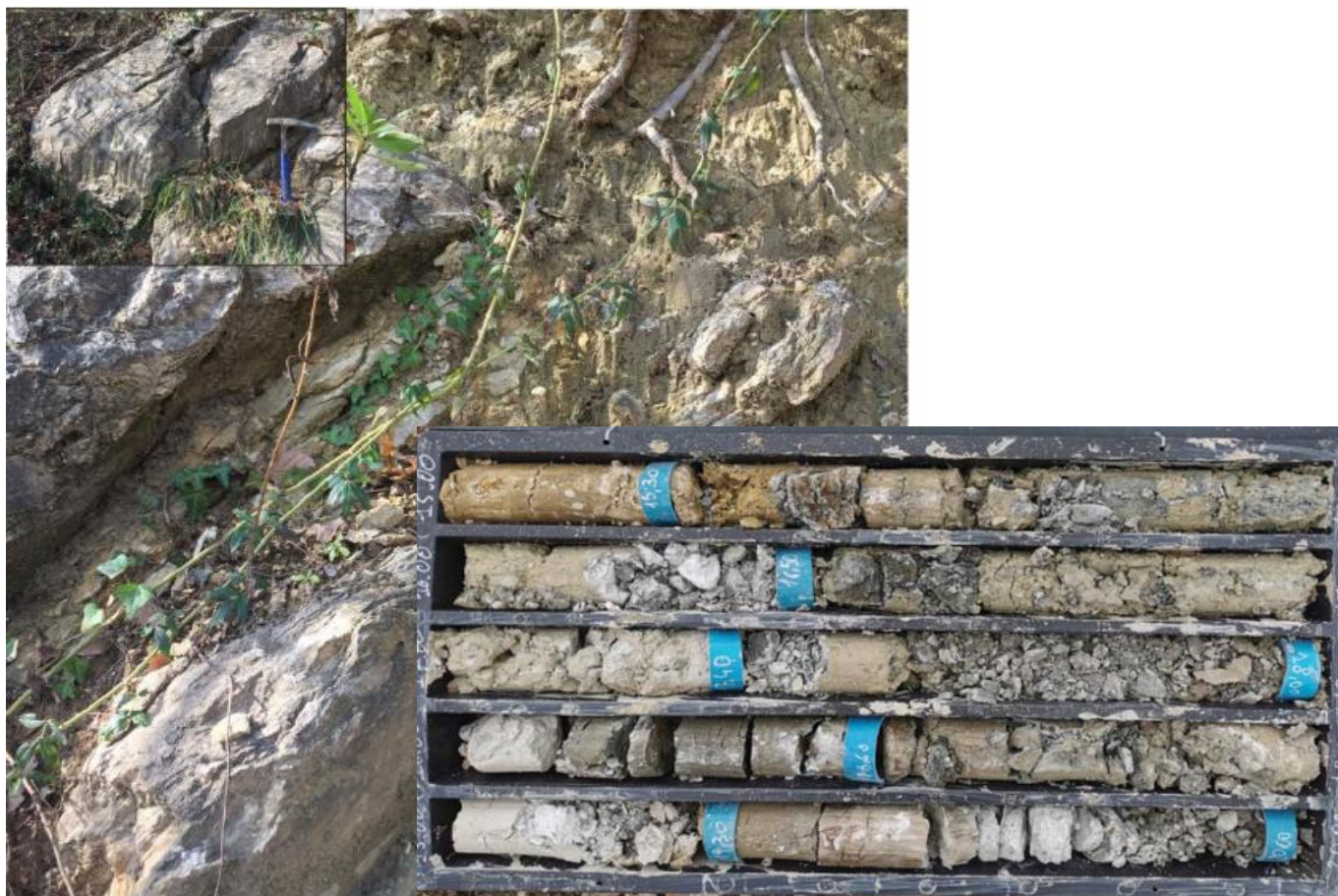
Figura 9-5: ALVb in affioramento e in sondaggio
