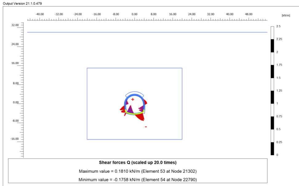
Figura 1-57. Rivestimento definitivo. Sforzo di taglio [kN/m /1000]
