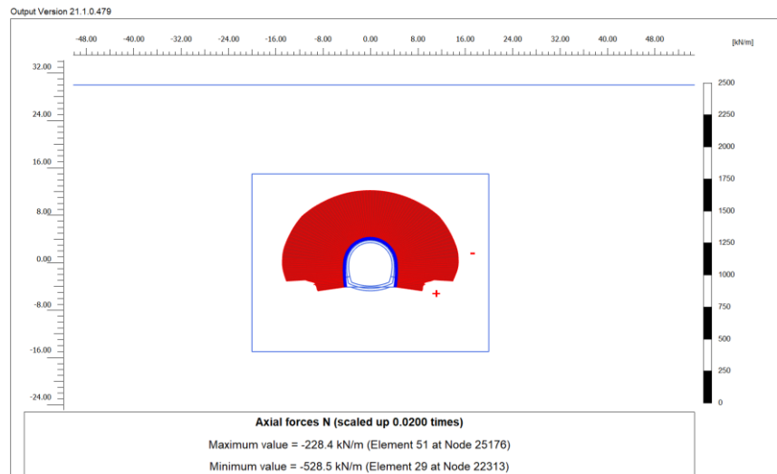
Figura 1-49. Rivestimento di prima fase. Sforzo normale [kN/m]
