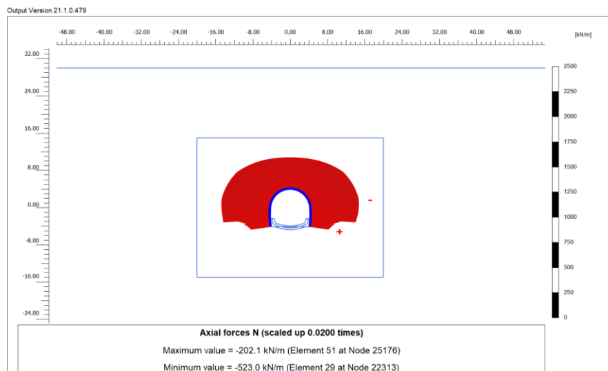
Figura 1-46. Rivestimento di prima fase. Sforzo normale [kN/m]
