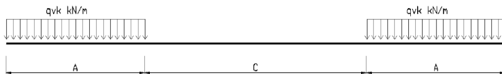
Figura 3 – Modello di carico LM71
