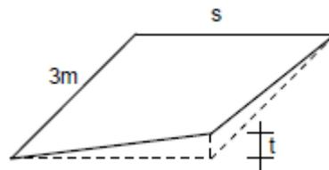
Figura 15: Sghembo ammissibile
