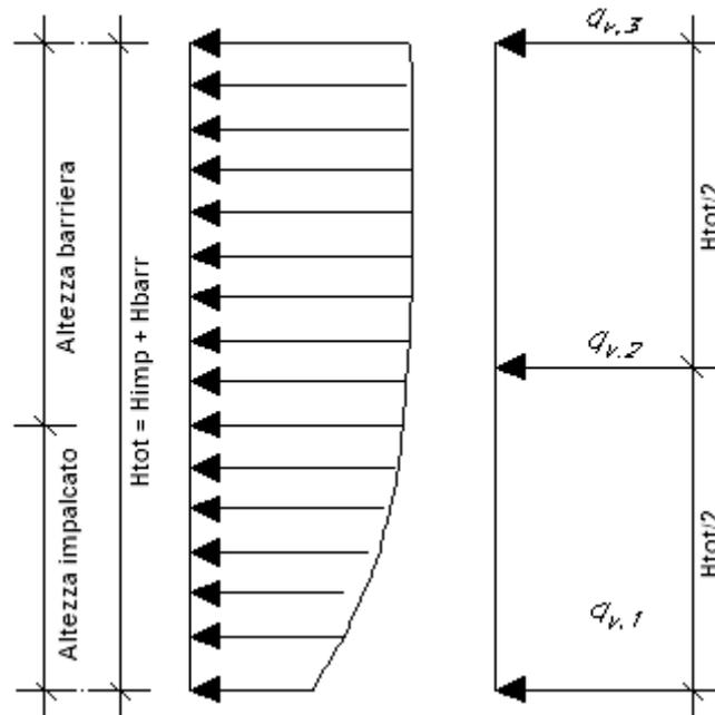
Ai fini delle analisi delle sottostrutture e quindi degli scarichi sugli apparecchi di appoggio si fa riferimento al caso di doppia barriera in quanto più gravoso ed in previsione di eventuali future integrazione degli elementi di mitigazione acustica.
