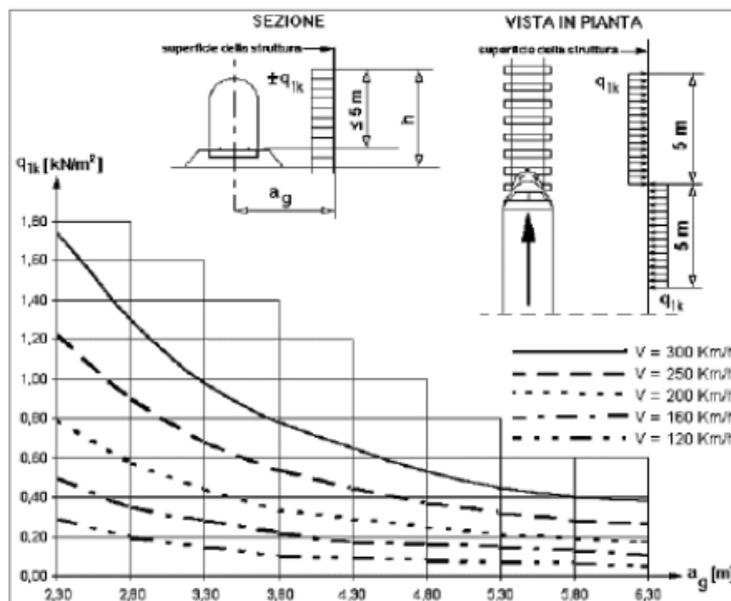
Figura 7: Valori caratteristici delle azioni  $q_{1k}$  per superfici verticali parallele al binario – da Fig. 5.2.8 -"Manuale di progettazione delle opere civili"
