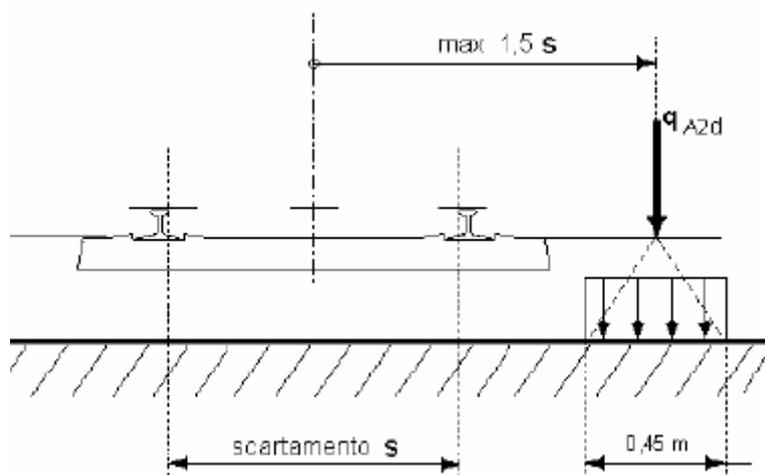
Figura 9: Deragliamento al di sopra del ponte – CASO 2
