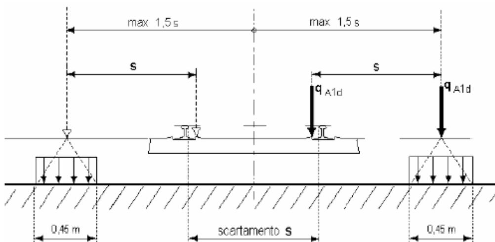
Figura 8: Deragliamento al di sopra del ponte – CASO 1
