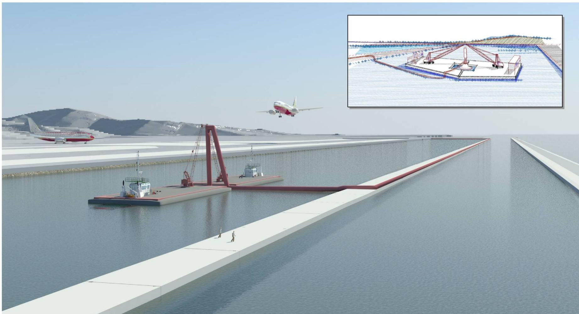
*Figura 12.13 - Versamento dello slurry all'interno della colmata - Schema del versamento*
