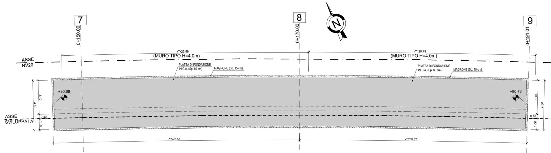
MURO DI SOSTEGNO - SVILUPPATA IN CORRISPONDENZA FILO INTERNO PARAMENTO
