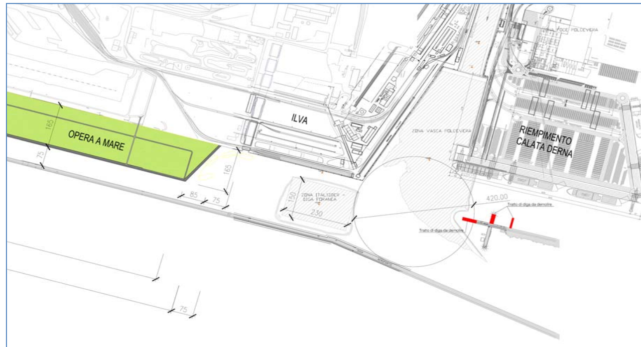
Figura 5-2 Interventi programmati all'imboccatura di Ponente del Bacino di Sampierdarena (in rosso i moli da demolire, in tratteggio le aree sottoposte a dragaggio)
